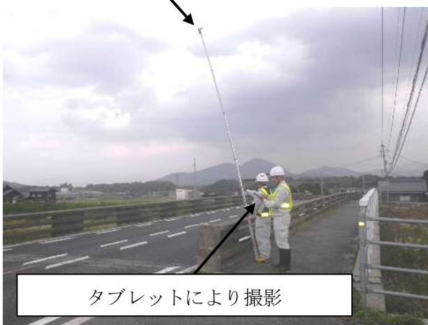
写真2.1.1 遠隔カメラによる橋面撮影状況
