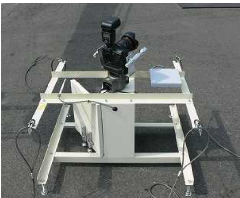
写真 3 無線リモート撮影装置
