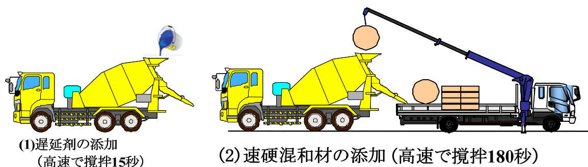
図-11 遅延剤および速硬混和材の添加
