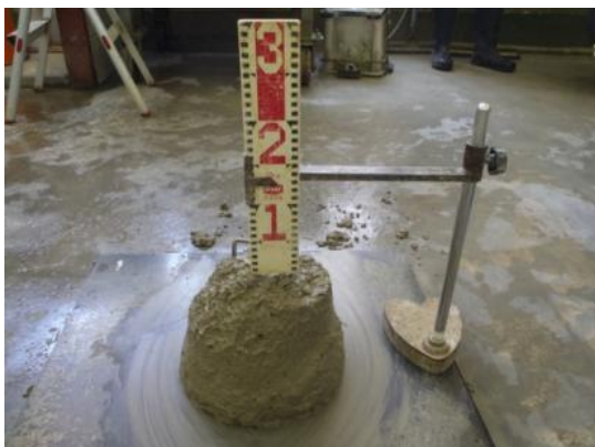
図-6 速硬コンクリートのスランプ試験
